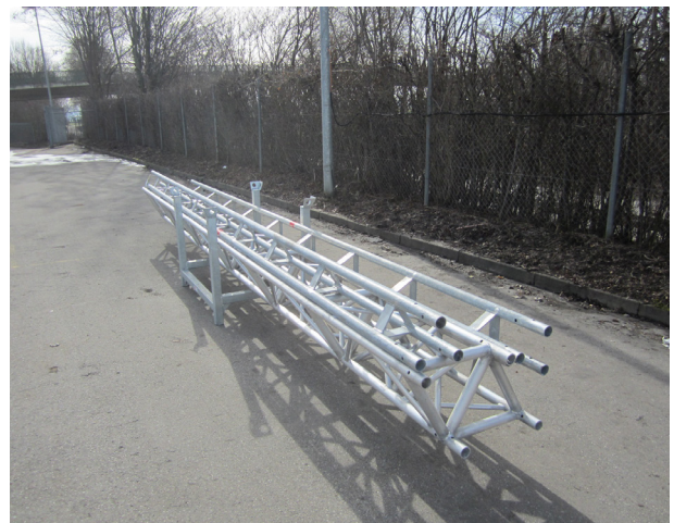
Modul-Palette 610 befüllt mit zwei Dreirohrständer und zwei Alu-Dreick-Gitterträger.
