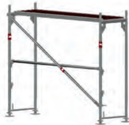
Vertikaldiagonale und Gerüstbelag einbauen
